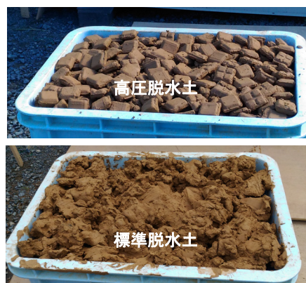
図 2-3 脱水土の状況
