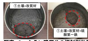
写真-6 ふり分け残留物の抑制剤効果
