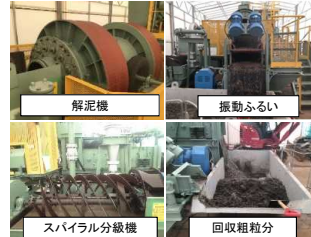
写真-7 湿式分級試験処理状況
